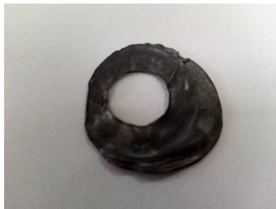
Bild 4 Zerschlossene Bleidichtung (Fass)
