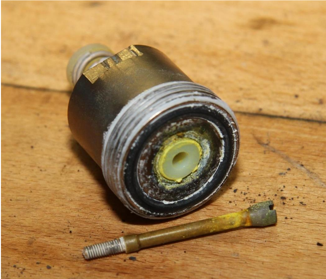
Bild 10 Chlorreaktionsprodukt mit Feuchtigkeit und Eisen
